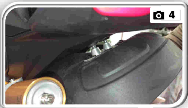
IT Smontaggio viti carter cilindro posteriore. EN Disassembly of the rear cylinder housing screws. DE Ausbau der Gehäuse-Schrauben des hinteren Zylinders. FR Démontage des vis du carter du cylindre arrière. ES Desmontaje de los tornillos del cárter del cilindro trasero. PT Desmontagem dos parafusos do cárter do cilindro de pressão.
