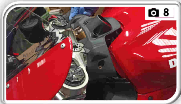
IT Smontaggio cover blocchetto accensione. EN Disassembly of the ignition switch cover. DE Ausbau der Zündschlosses-Abdeckung. FR Dépose du couvercle du bloc d'allumage. ES Desmontaje de la tapa de la cerradura de encendido. PT Desmontagem da tampa da ignição.
